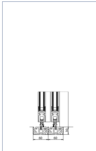
Podlahové vedení: Průběžné
