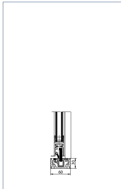
Podlahové vedení: Průběžné
